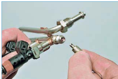
Колпачком колесного вентиля выворачиваем золотник из штуцера топливной рампы (для наглядности показано на снятой рампе)...
