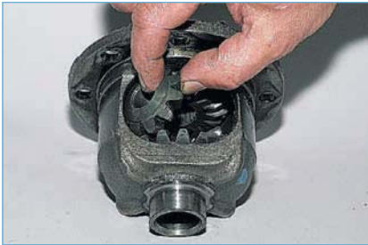
Проворачивая сателлиты, вынимаем их из коробки дифференциала.
