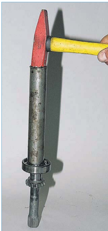
...подшипник вала привода переднего моста (труба должна опираться на внутреннее кольцо)...
