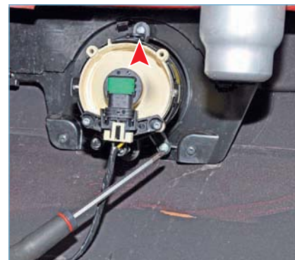
Крестообразной отверткой отворачиваем три самореза крепления фары к бамперу...
