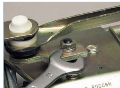
Ключом «на 13» отворачиваем гайку крепления кривошипа к валу мотор-редуктора.
