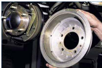
Снимаем тормозной барабан. Если барабан снять не удается...
