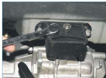
Накидным ключом «на 17» отворачиваем гайку крепления левого кронштейна подвески к раздаточной коробке.
