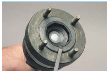
Отверткой поддеваем заглушку...
