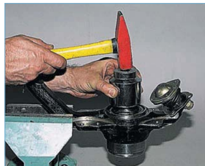
Инструментальной головкой подходящего размера или отрезком трубы запрессовываем сальники.
