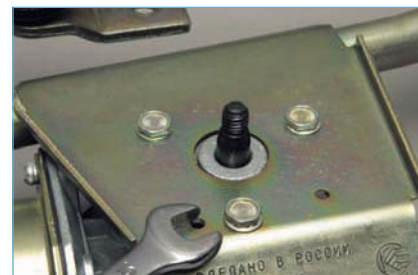
Ключом «на 10» отворачиваем три болта крепления мотор-редуктора к кронштейну.
