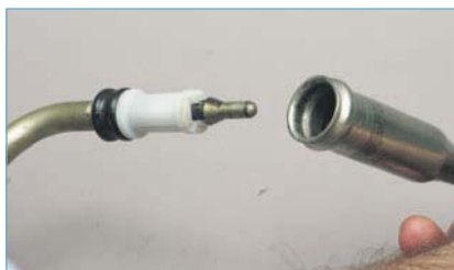
Снимаем стержень рычага. Поддев отверткой, извлекаем из отверстия стержня...
