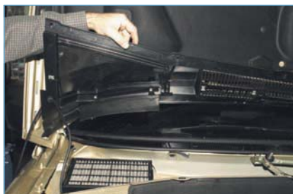
Приподняв накладку, сдвигаем ее вперед, чтобы она вышла из-под окантовки, приклеенной к ветровому стеклу...
