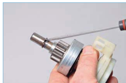
Поддеваем отверткой и снимаем запорное кольцо.
