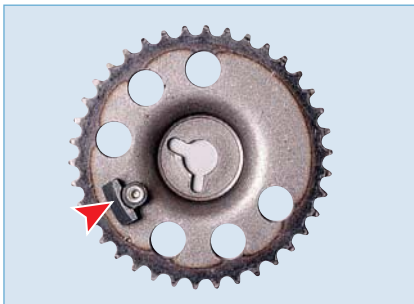
Расположение задатчика на звездочке распределительного вала
