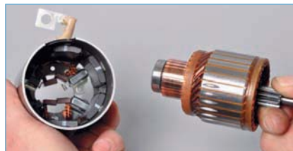
Вынимаем из корпуса якорь стартера...
