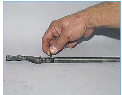
Вынимаем блокировочный сухарь из отверстия в штоке.
