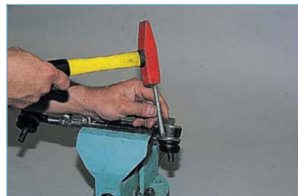
Вынимаем шаровой палец из проушины рычага поворотного кулака. Съемником выпрессовываем шаровой палец тяги из маятникового рычага.
