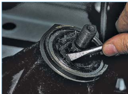
Шлицевой отверткой поддеваем сальник ведущей шестерни...
