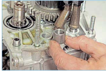
Снимаем втулку, которая осталась после демонтажа штока на задней плоскости картера коробки передач.
