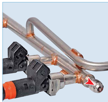
Штуцер контроля давления топлива (показан стрелкой).
