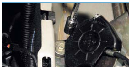
Головкой «на 10» отворачиваем болт среднего крепления стеклоочистителя.
