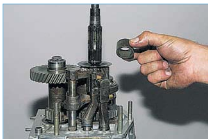
Снимаем распорную втулку...
