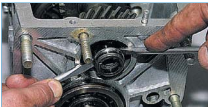
Двумя отвертками спрессовываем заднее внутреннее кольцо подшипника...
