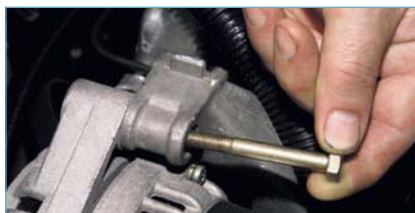
Придерживая генератор, вынимаем болт...
