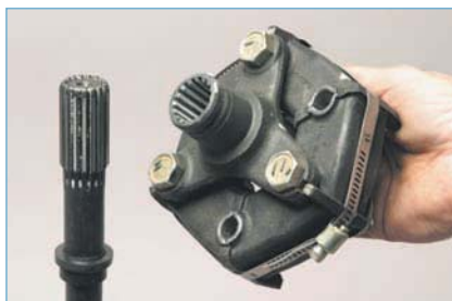
...фланец в сборе с муфтой...
