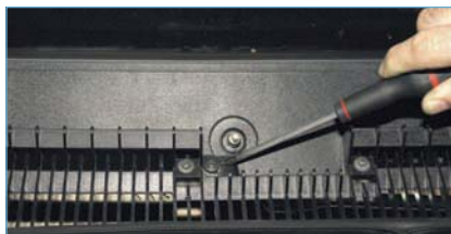
...и винт среднего крепления накладки.
