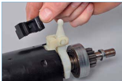
Снимаем резиновую заглушку.
