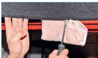
Поддев отверткой, отделяем обивку двери от внутренней панели двери. Чтобы не повредить лакокрасочное покрытие, подкладываем под отвер-
