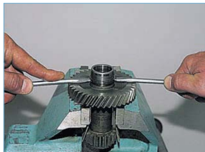
Двумя отвертками спрессовываем внутреннее кольцо подшипника блока шестерен...
