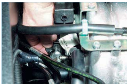
Отворачиваем пластмассовый колпачок штуцера на топливной рампе
