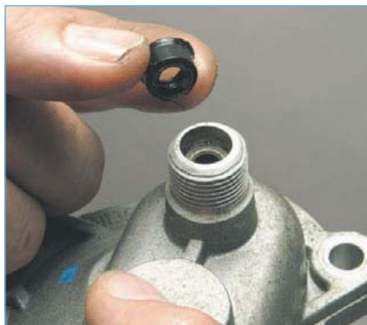
Извлекаем из корпуса резиновый уплотнитель валика.
