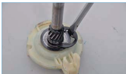
Отверткой сдвигаем из проточки стопорное кольцо и снимаем его.
