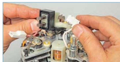
Снимаем регулятор напряжения и отсоединяем колодку провода от вывода регулятора напряжения.
