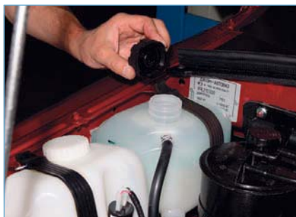
Отворачиваем крышку расширительного бачка...
