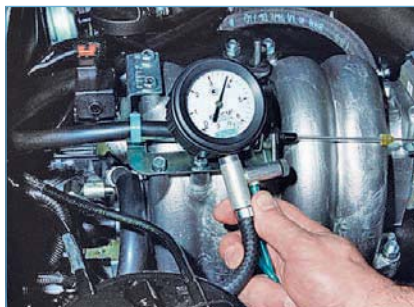
...измеряем давление топлива в системе, которое должно быть равным 3,6–4,0 бар.
