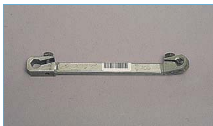
Ключ для штуцеров тормозных трубок
