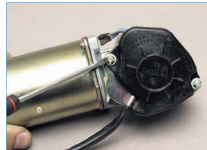
Отверткой отворачиваем два винта...
