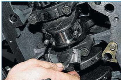
Снимаем крышку шатуна.
