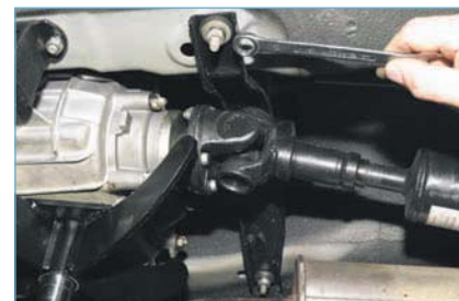
Накидным ключом или головкой «на 13» отворачиваем две гайки крепления поперечины заднего кронштейна к кузову.
