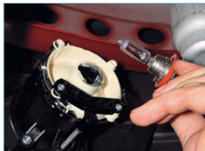
Повернув лампу против часовой стрелки, вынимаем ее из корпуса фары.
