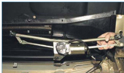
Снимаем стеклоочиститель ветрового стекла в сборе.
