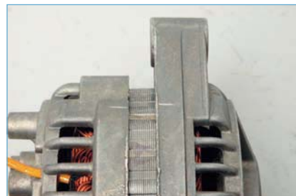
Помечаем взаимное положение статора и крышек генератора.
