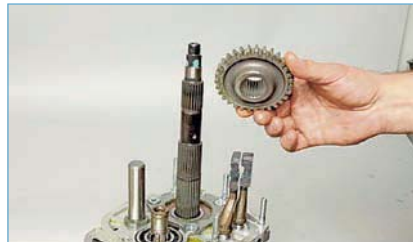
...и ведомую шестерню задней передачи.
