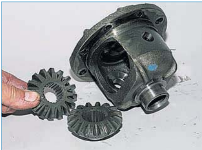
Вынимаем полуосевые шестерни...
