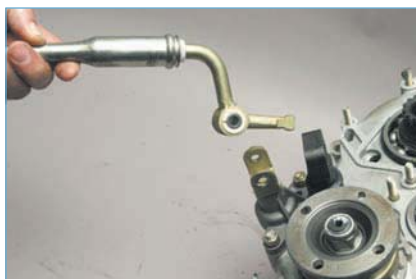
Снимаем рычаг управления. Вынимаем из отверстия рычага...
