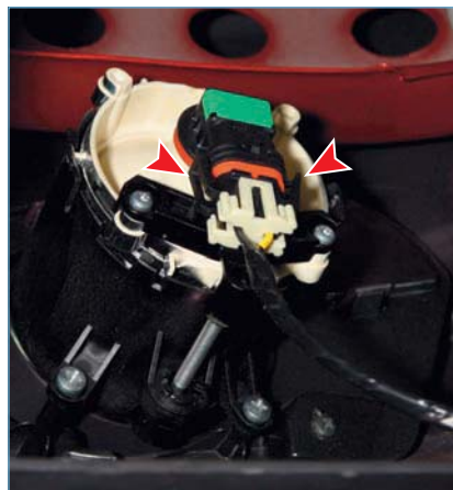
Отжимаем два фиксатора колодки проводов...
