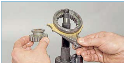
Снимаем вилку включения V передачи и передачи заднего хода вместе с муфтой синхронизатора и промежуточной шестерней заднего хода.
