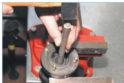
...и, нанося удары через выколотку из мягкого металла по торцу вала...
