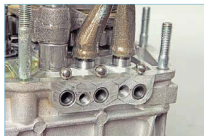
Намагнитенной отверткой вынимаем все три фиксатора.
