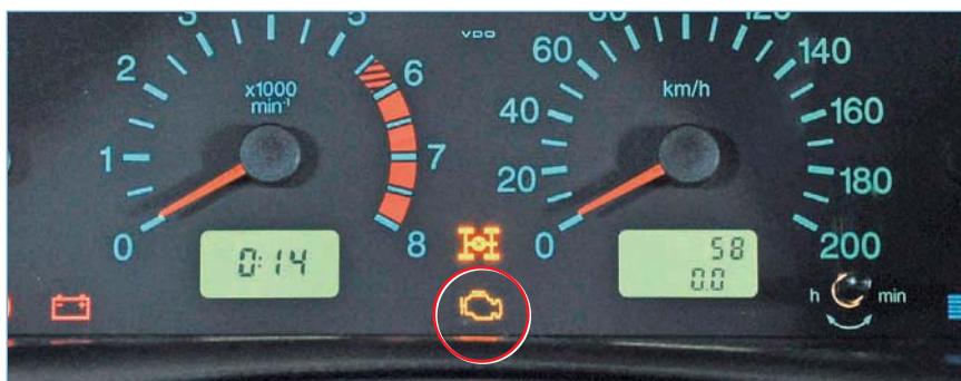
Сигнализатор неисправности системы управления двигателем в комбинации приборов
