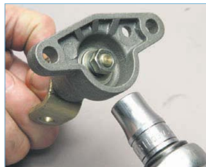
Удерживая вилку, головкой «на 13» отворачиваем гайку крепления оси вилки...
