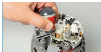
Крестообразной отверткой отворачиваем винт крепления конденсатора.
