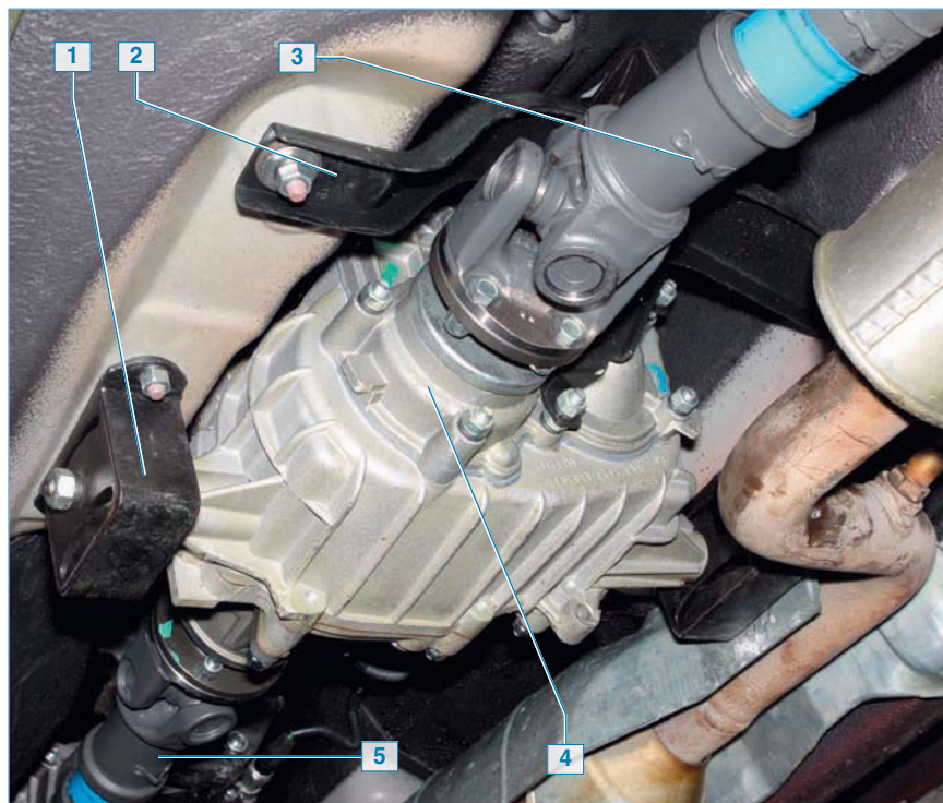
Вид на заднюю сторону раздаточной коробки: 1 — левый кронштейн подвески; 2 — поперечина заднего кронштейна подвески; 3 — задний карданный вал; 4 — задняя крышка раздаточной коробки; 5 — передний карданный вал
