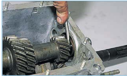
Вставив отвертку между торцами подшипника и шестерни I передачи промежуточного вала, сдвигаем задний подшипник.
