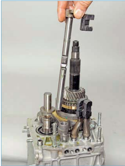
Вынимаем шток включения V передачи и передачи заднего хода.
