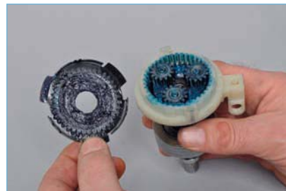
...и снимаем крышку планетарного редуктора.
