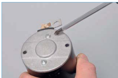
Крестообразной отверткой отворачиваем два винта...
