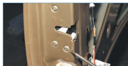
Крестообразной отверткой отворачиваем три винта крепления замка к двери...
