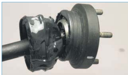
Стягиваем чехол с корпуса шарнира...
