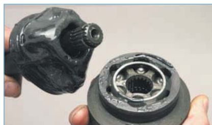
...выбиваем вал из шарнира.
