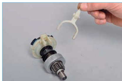
...и снимаем рычаг привода.
