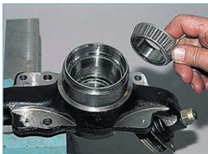
Вынимаем внутреннее кольцо наружного подшипника с сепаратором и роликами.
