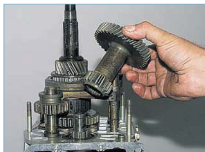
...и снимаем блок шестерен со шлицев промежуточного вала. Зажимаем блок шестерен V передачи и заднего хода в тиски с накладками губок из мягкого металла.
