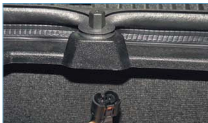
Отсоединяем колодку проводов от выключателя подкапотной лампы.
