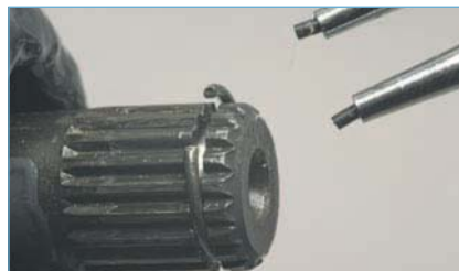
Специальными щипцами разжимаем стопорное кольцо...
