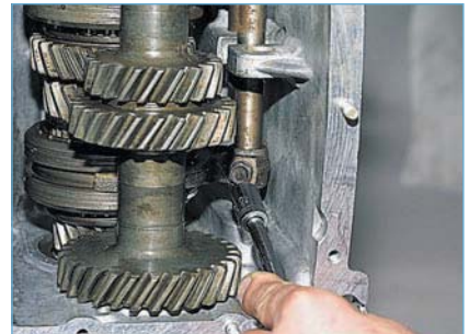
Головкой «на 10» отворачиваем болт крепления вилки включения III-IV передач к штоку.
