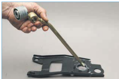
Вынимаем рычаг переключения передач в сборе с ползуном из опорной пластины.
