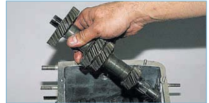
...вынимаем его из картера коробки передач.
