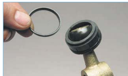
Снимаем с опоры рычага нижнее уплотнительное кольцо.
