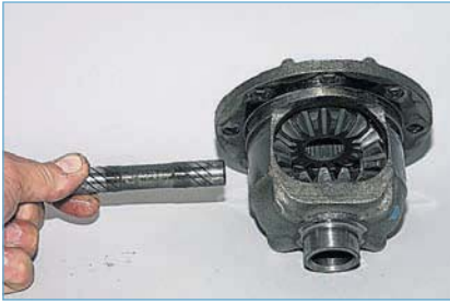
Вынимаем ось сателлитов.
