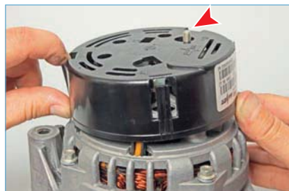
Поочередно отжимаем три пластмассовые защелки...
