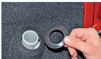
Снимаем облицовку горловины бачка.
