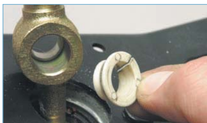
...вынимаем из отверстия рычага две пластиковые втулки. При необходимости втулки заменяем новыми.
