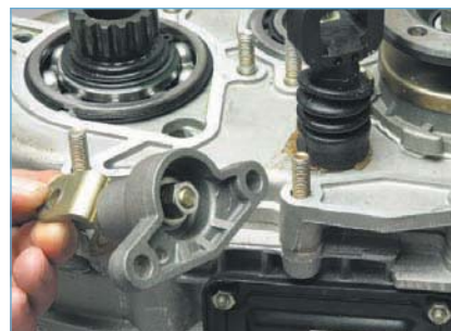
...и снимаем кронштейн в сборе с вилкой.
