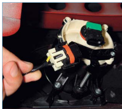
...и отсоединяем колодку от лампы.
