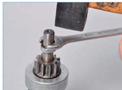
...и ударив молотком по ключу, спрессовываем ограничительное кольцо.
