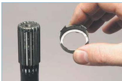
Обойму сальника снимаем с вала только для ее замены.
