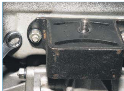
Накидным ключом или головкой «на 13» отворачиваем две гайки крепления левого кронштейна к кузову.
