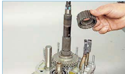
Снимаем ступицу муфты синхронизатора...
