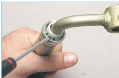
Отверткой выводим лепестки запорной втулки из канавки стержня рычага...
