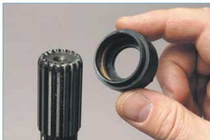
...и снимаем его с переднего конца вала.
