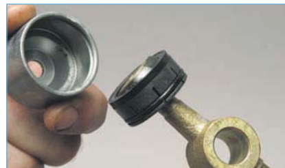
Снимаем ползун шаровой опоры рычага переключения передач.
