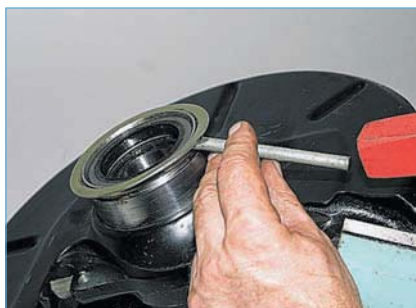
Зубилом сбиваем грязезащитное кольцо.
