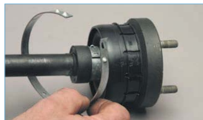
...разъединяем и снимаем хомут.
