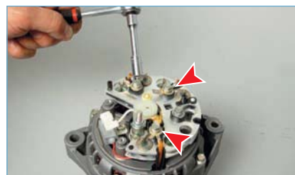
Головкой «на 8» отворачиваем четыре болта крепления выпрямительного блока.
