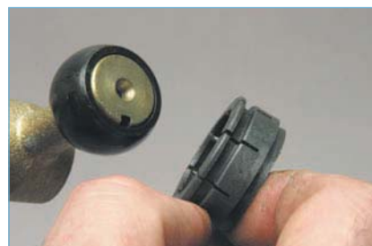
Снимаем опору с рычага переключения передач.
