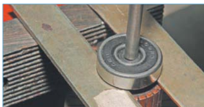
Вставляем две металлические пластины между подшипником и коллектором якоря и опираем их на губки тисков нанося удары молотком через выколотку из мягкого металла в торец вала, спрессовываем подшипник.
