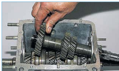
Сдвинув промежуточный вал назад...
