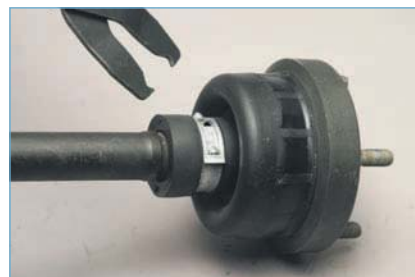
Сжав щипцами хомут крепления чехла и обоймы клапана...
