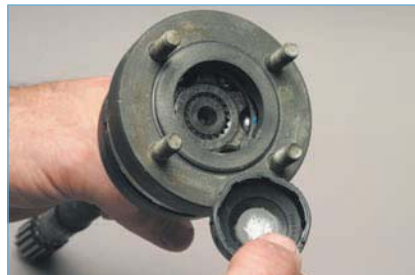
...и вынимаем ее из корпуса шарнира. Опираем корпус шарнира о губки тисков...
