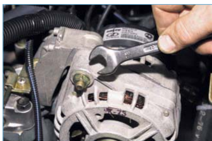
Ключом «на 13» отворачиваем гайку болта верхнего крепления генератора.
