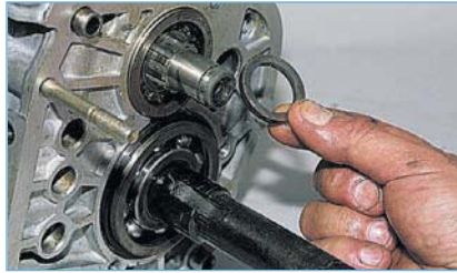
Вынимаем упорное кольцо заднего подшипника промежуточного вала.
