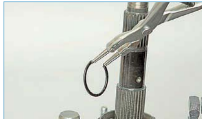
Специальными щипцами снимаем со вторичного вала стопорное кольцо.
