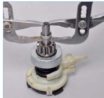
Ограничительное кольцо хода приводной шестерни устанавливаем на стопорное кольцо при помощи раздвижных пассатижей.
