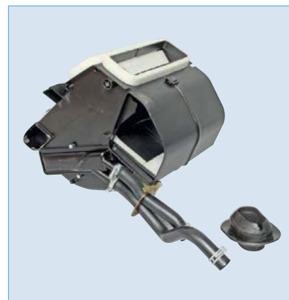
Радиатор отопителя в корпусе со шлангами подвода и отвода охлаждающей жидкости
