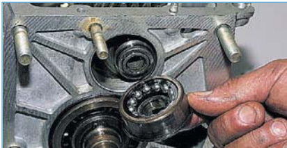
...и снимаем подшипник. При снятии подшипника его заднее внутреннее кольцо может остаться на валу.
