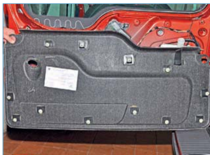
Расположение пистонов с внутренней стороны обивки.
