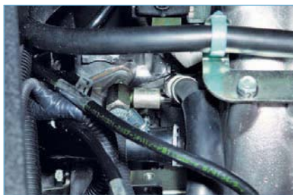
Наворачиваем на штуцер рампы наконечник приспособления.
