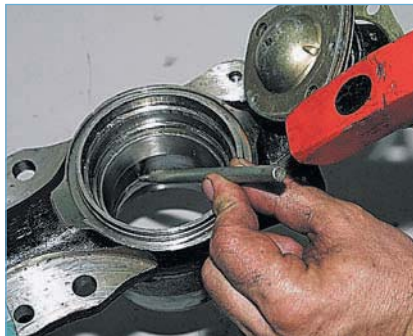
Бородком выбиваем наружное кольцо наружного подшипника...
