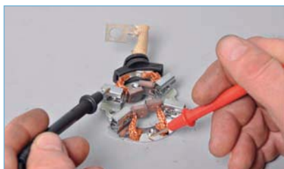
Проверяем держатели изолированных щеток на замыкание с «массой».
