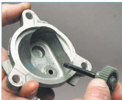
...выталкиваем валик с шестерней из корпуса.
