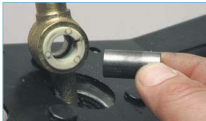
Вынимаем из рычага металлическую дистанционную втулку. Поддев отверткой...
