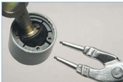
Съемником стопорных колец сжимаем стопорное кольцо...
