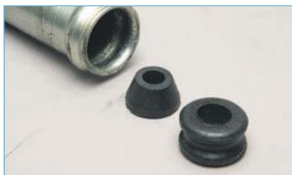
...резиновую втулку и упорную подушку. Разжав лепестки дистанционной втулки...
