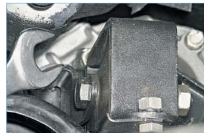
...удерживая болт от проворачивания ключом «на 17».
