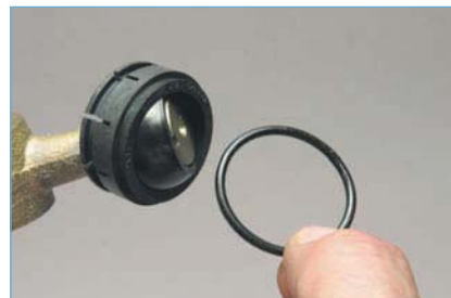
...снимаем верхнее уплотнительное кольцо.
