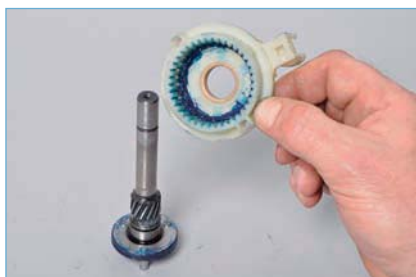
...и коронную шестерню планетарного редуктора.
