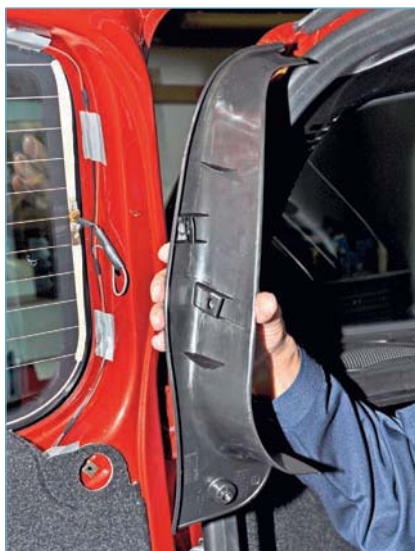
Снимаем левую накладку двери.
