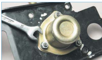
Ключом «на 10» отворачиваем три гайки крепления корпуса шаровой опоры...
