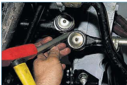
Палец также можно выпрессовать, нанеся резкий удар снизу молотком
