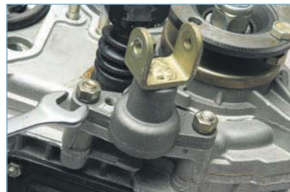
Ключом «на 13» отворачиваем две гайки крепления кронштейна рычага управления...
