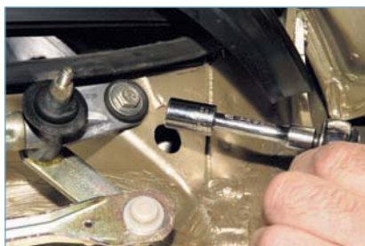
Головкой «на 10» с удлинителем отворачиваем болты левого...
