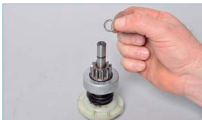
Снимаем ограничительное кольцо хода шестерни привода.
