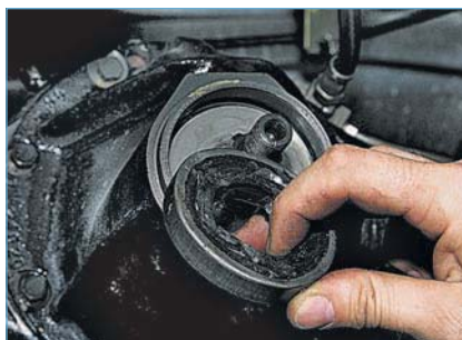
Шлицевой отверткой поддеваем сальник ведущей шестерни...
