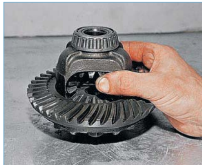
Проверяем легкость вращения шестерен дифференциала.
