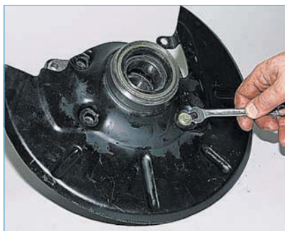
Ключом «на 10» отворачиваем болт крепления защитного кожуха...
