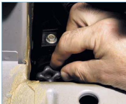
Отворачиваем крышку расширительного бачка...
