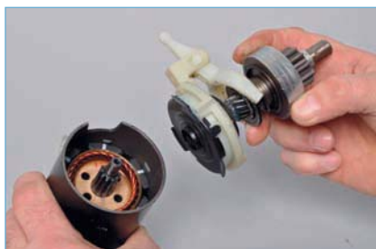
Снимаем привод в сборе.
