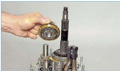
Снимаем шестерню V передачи с блокирующим кольцом синхронизатора.
