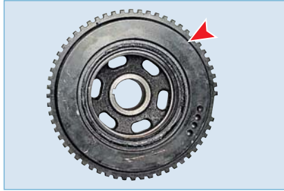
Задающий диск датчика положения коленчатого вала на шкиве привода вспомогательных агрегатов.
