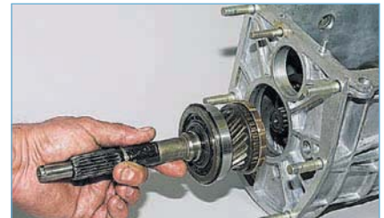
...вынимаем первичный вал в сборе с подшипником и блокирующим кольцом синхронизатора.
