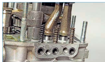
Вынимаем пружины фиксаторов (пружина штока V передачи и заднего хода длиннее двух других и имеет темный цвет покрытия)
