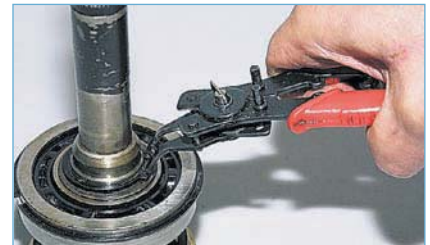
Щипцами разжимаем стопорное кольцо...
