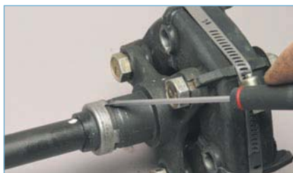
Отверткой отгибаем четыре лепестка обоймы сальника...
