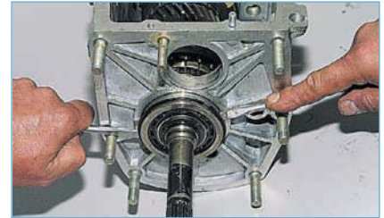
Поддев двумя отвертками за установочное кольцо задний подшипник первичного вала...
