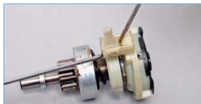
Поочередно отжимая отверткой проушины опоры, второй отверткой выталкиваем рычаг из проушины...
