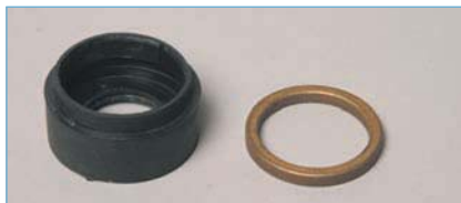
В резиновой обойме клапана установлено металлокерамическое кольцо.
