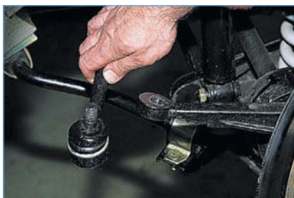
Вынимаем шаровой палец из проушины рычага поворотного кулака. Съемником выпрессовываем шаровой палец тяги из маятникового рычага.
