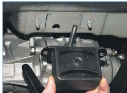
...снимаем левый кронштейн подвески.
