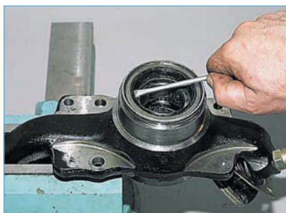
Поддеваем отверткой сальник...
