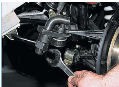
Съемником выпрессовываем шаровой палец из рычага.
