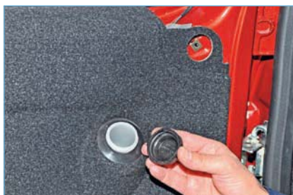
Отворачиваем пробку бачка омывателя стекла двери.
