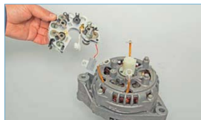
Снимаем выпрямительный блок.
