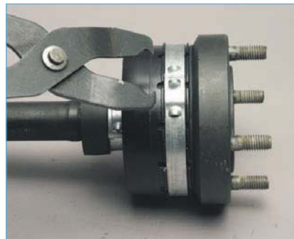
Сжав специальными щипцами (или раздвижными пассатижами) хомут крепления кожуха и чехла к корпусу шарнира...
