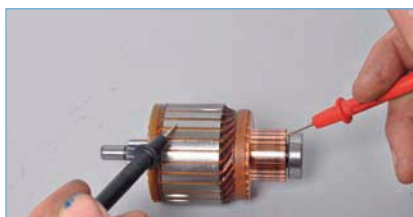
Омметром проверяем замыкание обмотки якоря на его сердечник.
