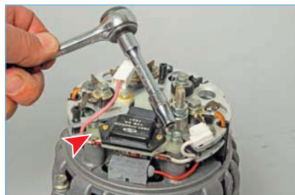
Головкой «на 6» отворачиваем два болта крепления регулятора напряжения.
