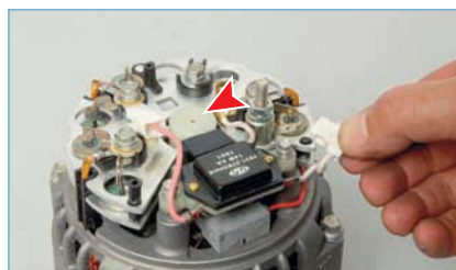
Отсоединяем две колодки проводов регулятора напряжения от выводов выпрямительного блока.
