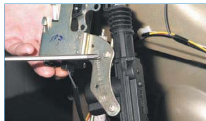
Крестообразной отверткой отворачиваем два самореза...
