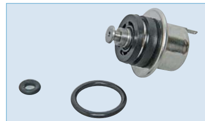
Регулятор давления топлива с уплотнительными кольцами
