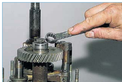
Накидным ключом (или головкой) «на 17» отворачиваем болт крепления блока шестерен V передачи и заднего хода.
