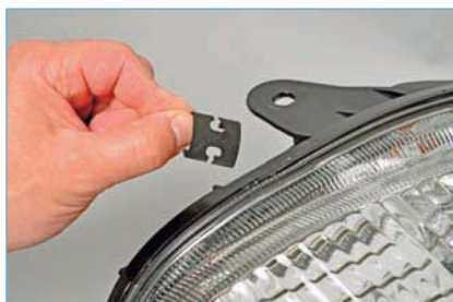
...снимаем семь защелок крепления стекла.
