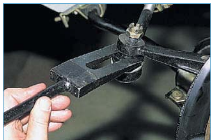
Можно использовать вильчатый съемник.
