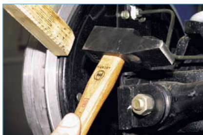
Снимаем тормозной барабан. Если барабан снять не удается...
