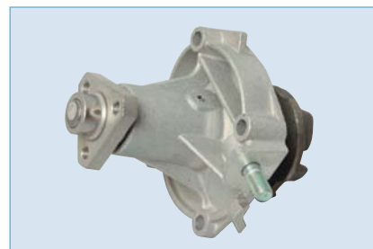
Крышка насоса охлаждающей жидкости в сборе с валиком, ступицей, сальником, подшипником и крыльчаткой
