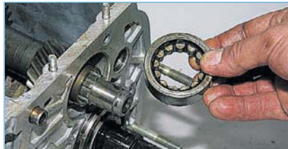
Вынимаем наружное кольцо подшипника с сепаратором и роликами.
