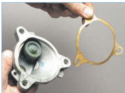
Соединение уплотнено прокладкой.
