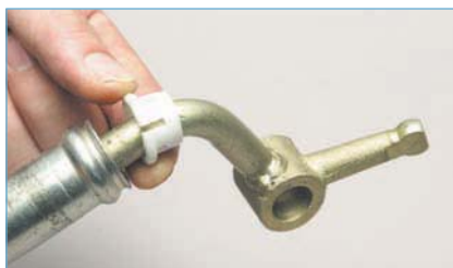
...и извлекаем втулку из стержня рычага.
