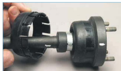
Стягиваем кожу с чехла корпуса шарнира...
