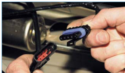
Разъединяем колодки проводов стеклоочистителя и жгута проводов.
